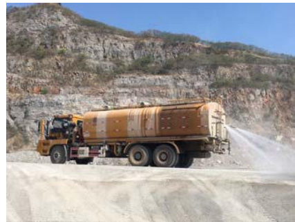
รูปที่ 2-4: การฉีดพรมน้ำบริเวณหน้าเหมือง
